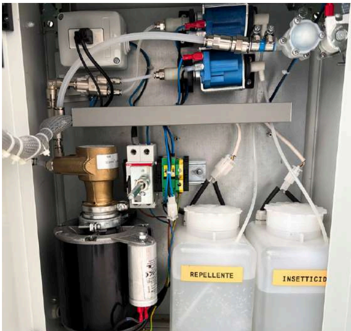
Figura 5 - Zona "Q": circuito elettrico della centralina
