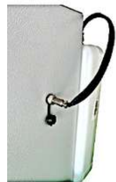
Figura 5 - Collegamento del galleggiante della tanica al connettore della centralina (DX)
