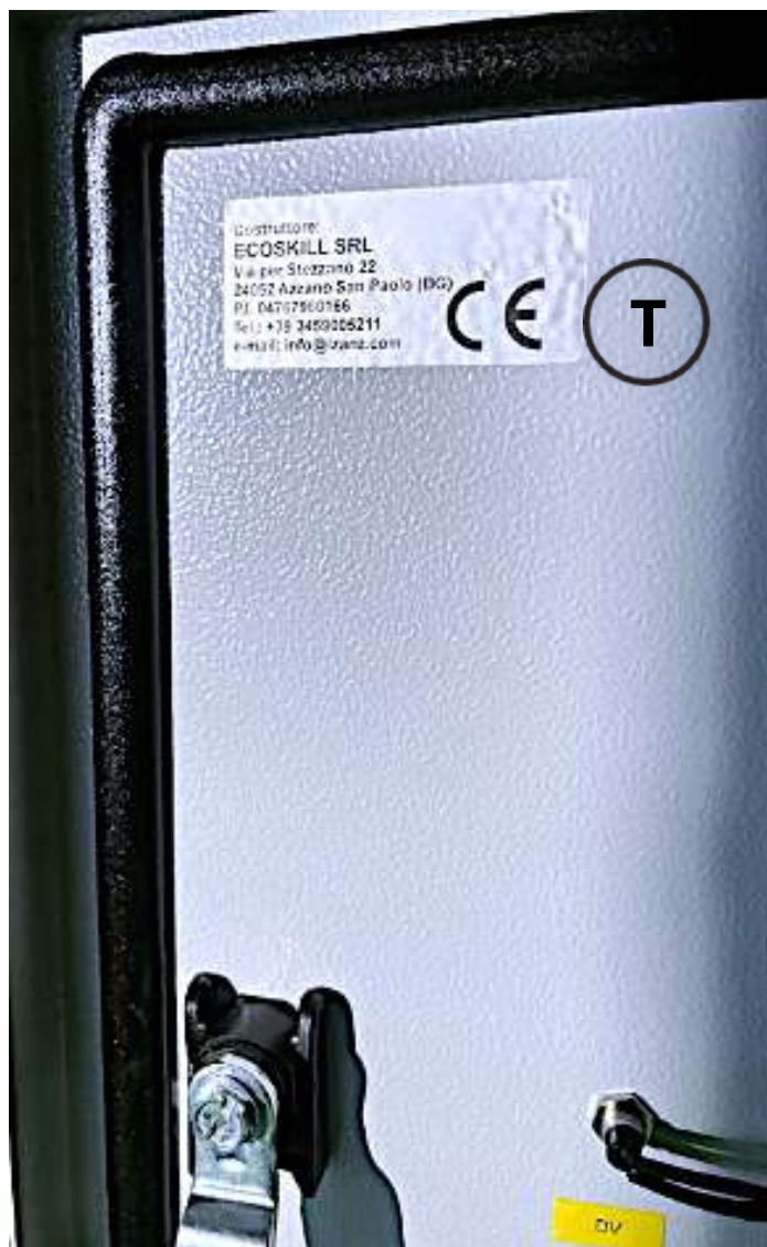
Figura 2 - Zona "T": identificazione targhetta marcatura CE
