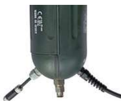
Figura 8: a sinistra connettore sensore di livello (passaparete grigio), al centro raccordo di ingresso della centralina, a destra cavo dell'alimentazione elettrica
